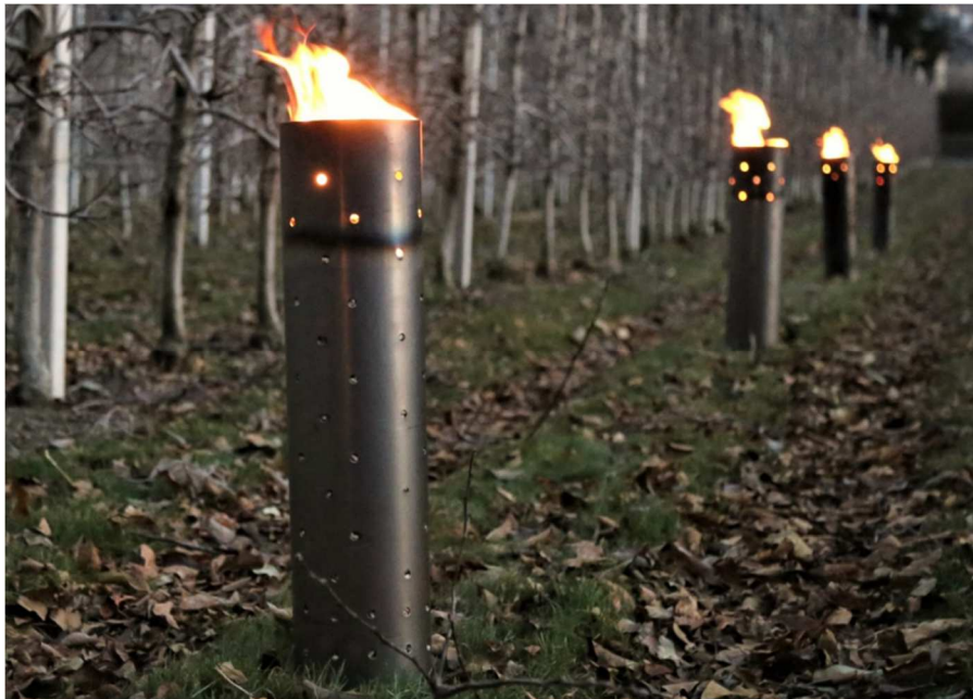
Bild 2: Pellet-Öfen, Brenndauer 7-8 Std mit 10 kg Befüllung
